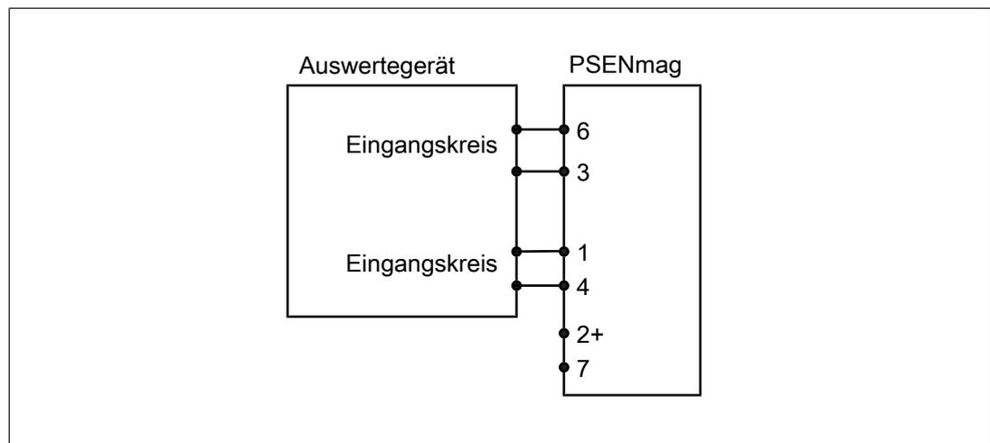
Abb.: Zweikanaliger Anschluss des PSEN ma1.3p-20 an den Eingangskreisen eines Auswertegeräts
