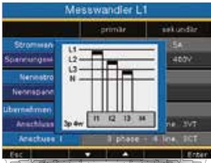
Abb.: Beispiel für die Konfiguration Strommessung über 3 Stromwandler in einem Dreiphasen 4 Leiter Netz am UMG 508 Display
